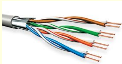
F/UTP ( ang. Foiled/Unshielded Twisted Pair ) - folia aluminiowa na czterech parach przewodów.
