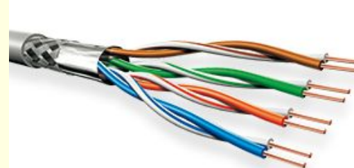
SF/UTP ( ang. Shielded/Foiled Twisted Pair ) — kabel skręcany z podwójnym zewnętrznym ekranem w postaci foliowego oplotu i siatki.
